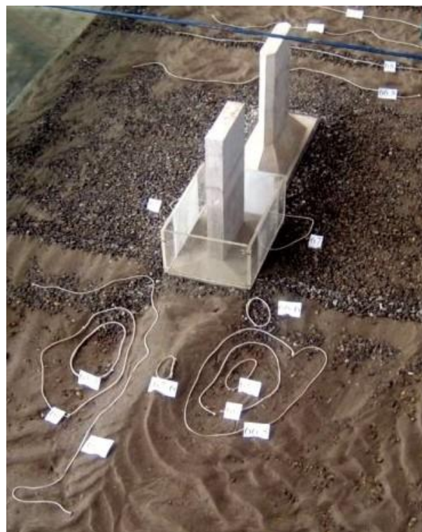
Slika 17. Fizički model za u nedistordovanoj razmeri 1:40 koji je izgrađen u laboratoriji Instituta “Jaroslav Černi” za ispitivanje lokalne erozije dunavskog korita oko zagata novog stuba mosta u Beškoj; pored deformacije korita, snimak prikazuje i projektovani zaštitni tepih od krupnog kamena [12].
