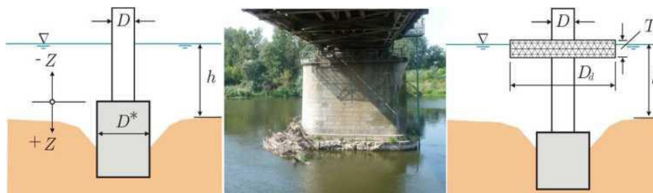
Slika 10. Ekvivalentni prečnik stuba i snimak naplava oko stuba mosta na V. Moravi kod Markovca.
