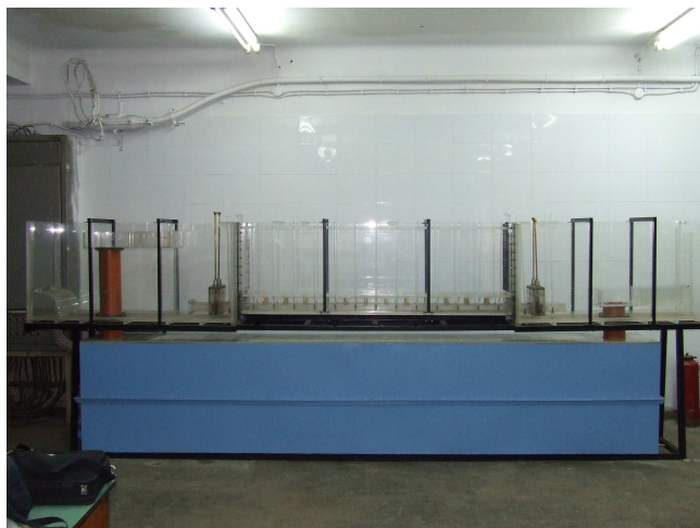
Слика 1. Изглед лабораторијске инсталације за хидраулично испитивање бродских преводница (Хидрауличка лабораторија Грађевинског факултета у Београду)
