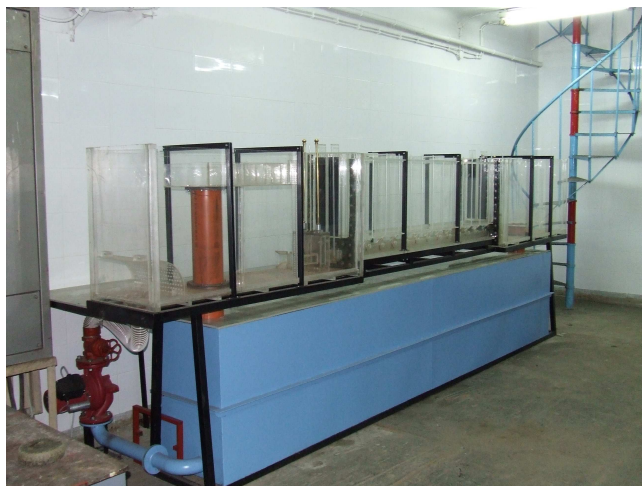
Слика 1. Изглед лабораторијске инсталације за хидраулично испитивање бродских преводница (Хидрауличка лабораторија Грађевинског факултета у Београду)
