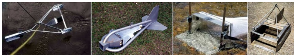
Slika 2.18: Hvatači vučenog nanosa: holandski BTMA, američki Helley-Smith BLS30, kutijasti USBS, srpski IJCerni [275, 117].
