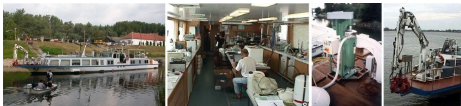
Slika 2.16: Istraživački brod „Argus”; sleva udesno: izgled broda; laboratorija sa mnoštvom instrumenata za ispitivanje kvaliteta vode i nanosa; uređaj za zahvatanje uzoraka vode i nanosa; grabilica za zahvatanje materijala sa rečnog dna.
