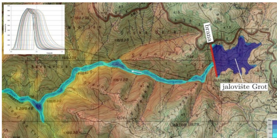
Slika 2.47: Numerička simulacija hidrauličkih posledica proloma brane jalovišta Grot kod mesta Kriva Feja u jugoistočnoj Srbiji [101]; na karti je ucrtana plavna zona nizvodno od brane; hidrografi prikazuju prostiranje poplavnog talasa (vode i jalovine), izazvanog prolomom brane trajanja (30 min); vršne vrednosti ( > 8000 \text{ m}^3/\text{s} ) daleko prevazilaze najveće protoke vodotoka nizvodno od brane u njegovom prirodnom režimu.
