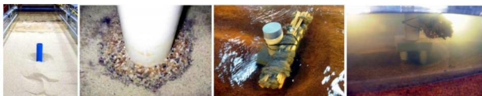
Slika 4.48: Laboratorijska ispitivanja lokalne erozije oko mostovskih stubova; sleva na desno: veličina i oblik erozione jame oko cilindričnog stuba, armirajući sloj, uticaj naplava (granja i balvana) na potkopavanje mostovskog stuba [45, 281].
