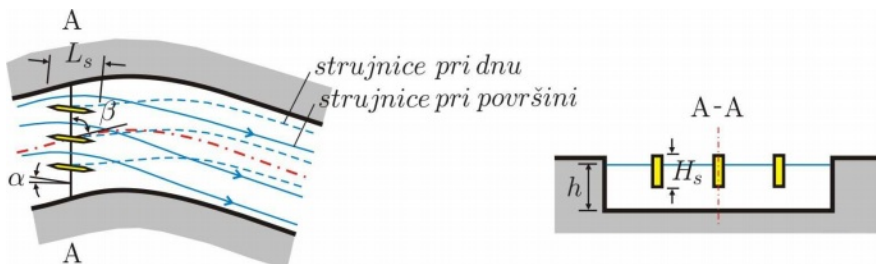
Slika 3.109: Sistem površinskih skretača sa osnovnim dimenzijama.
