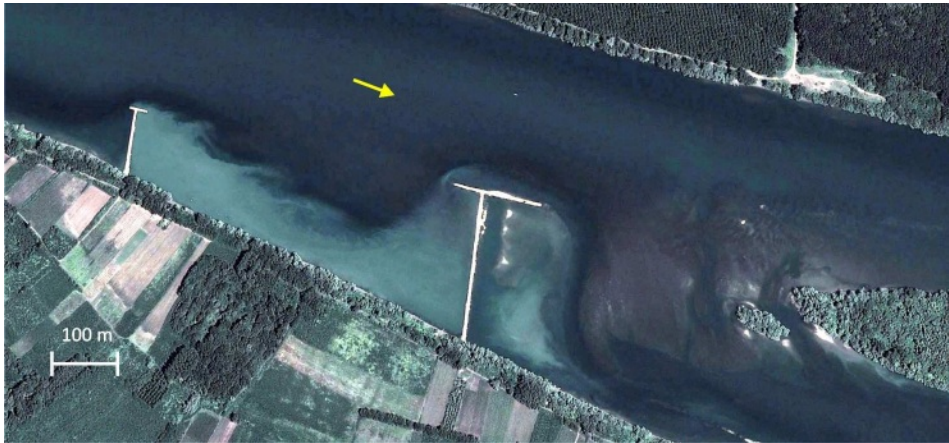
Slika 3.78: Reka Sava – sektor „Kamičak”, km 82 - km 88; nizvodni (glavni) naper dužine 260 m ima za cilj usmerenje toka ka levom, plovnom rukavcu; uzvodni, kraći naper štiti glavni naper od oštećenja pri velikim vodama koje prelivaju oba napera; svetlija boja ukazuje na zasuto, plitko korito (GoogleEarth®).
