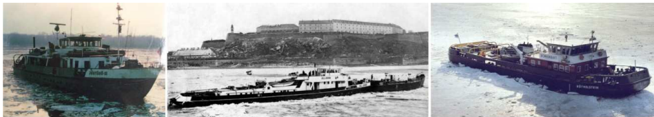
Slika 6.52: Razni tipovi ledolomaca; sleva u desno: klasični ledolomac koji svojim pramcem razbija ledene sante; ledolomački sastav broda potiskivača i dodatnog korita („ledolomca”), povezanih ekscentarskom spojnicom, tako da se led razbija vibracijama dodatnog korita koje se ne prenose na brod potiskivač; ledolomac koji razbija led naskokom na sante.
