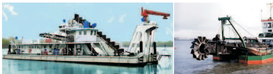
Slika 4.66: Primeri mehaničkih bagera; levo: bager-vedričar; desno: bager sa rotacionom zahvatnom glavom [280].
