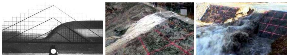
Slika 6.22: Eksperimenti proloma nasipa usled prelivanja; sleva udesno: peščani nasip [130]; nasipi od mešovitog i dominantno glinovitog tla [80].
