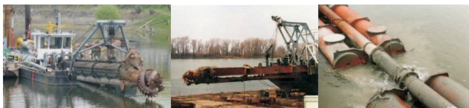
Slika 4.68: Primeri hidrauličkih bagera; levo: rotacioni sekač na vrhu usisne cevi [280]; sredina: bager refuler „Jadar” (Plovput-Beograd); desno: plutajući cevovod.
