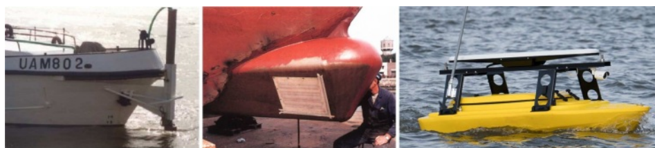
Slika 2.9: Uređaji za akustičko merenje dubine; sleva udesno: nosač single beam uređaja na pramcu broda; pločasti multibeam uređaj na trupu broda; multibeam uređaj sa daljinskim upravljanjem za merenje u plitkim oblastima [274].
