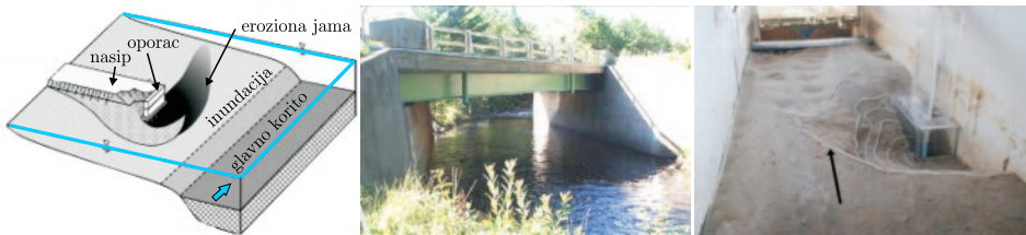
Slika 4.50: Mostovski oporci; s leva na desno: skica erozije oko oporca u inundaciji; oporci u glavnom koritu [152]; fizički model vertikalnog oporca [57].
