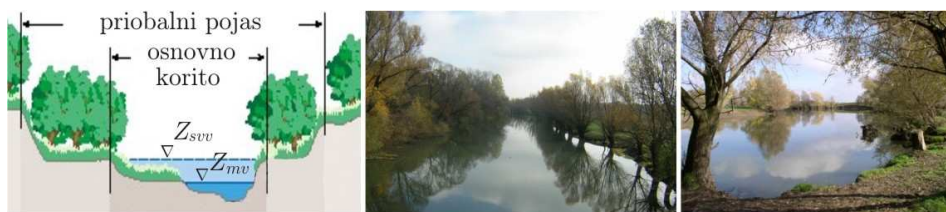
Slika 5.6: Ugledni poprečni presek i izgled korita reke Karaš.
