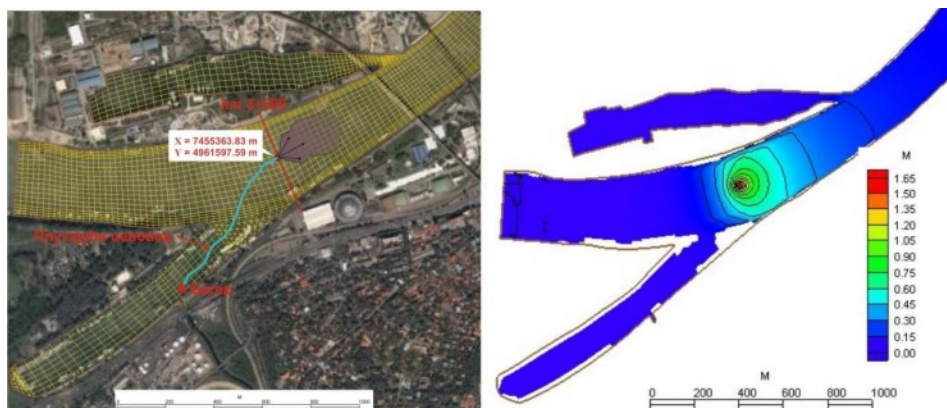
Slika 4.72: Bagerovanje Čukaričkog zaliva na reci Savi u Beogradu; levo: računsa mreža i mesto ispuštanja izbagerovanog materijala; desno: numerička simulacija lokalnog zasipanja korita posle 465 sati neprekidnog bagerovanja pri protoku male vode ( 500 \text{ m}^3/\text{s} ) [115].
