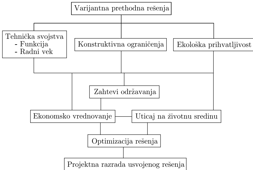
Slika 1.1: Put do izbora optimalne regulacione građevine, čija su zahtevana tehnička svojstva: stabilnost, dugotrajnost, sigurnost, ekonomska opravdanost, ekološka i socijalna prihvatljivost [199].
