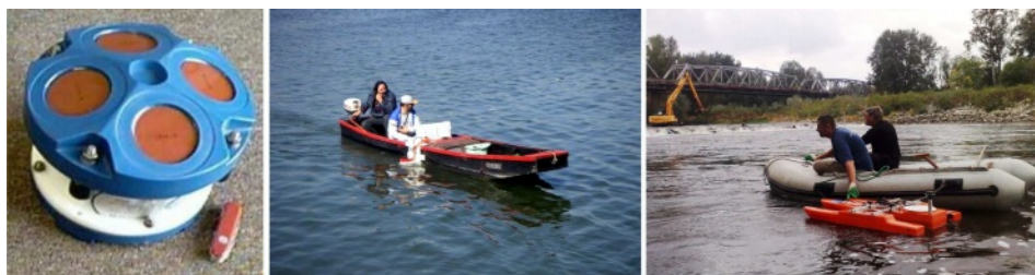
Slika 2.14: Oprema ADCP uređaja za snimanje brzine toka.
