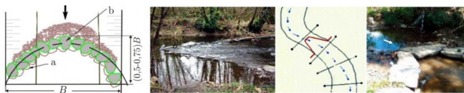
Slika 5.12: Prelivi od kamena; levo: lučni preliv, a – podloga, b – upušten kamen kao otvor za malu vodu; u sredini: potopljen V preliv; desno: V preliv od kamenih ploča [209, 37].
