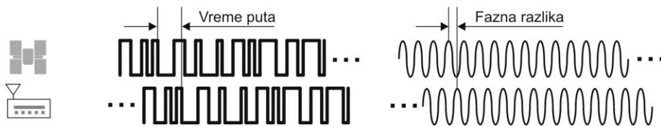
Slika 6.8. Princip merenja GPS prijemnika upoređenjem kopije i originala signala.
