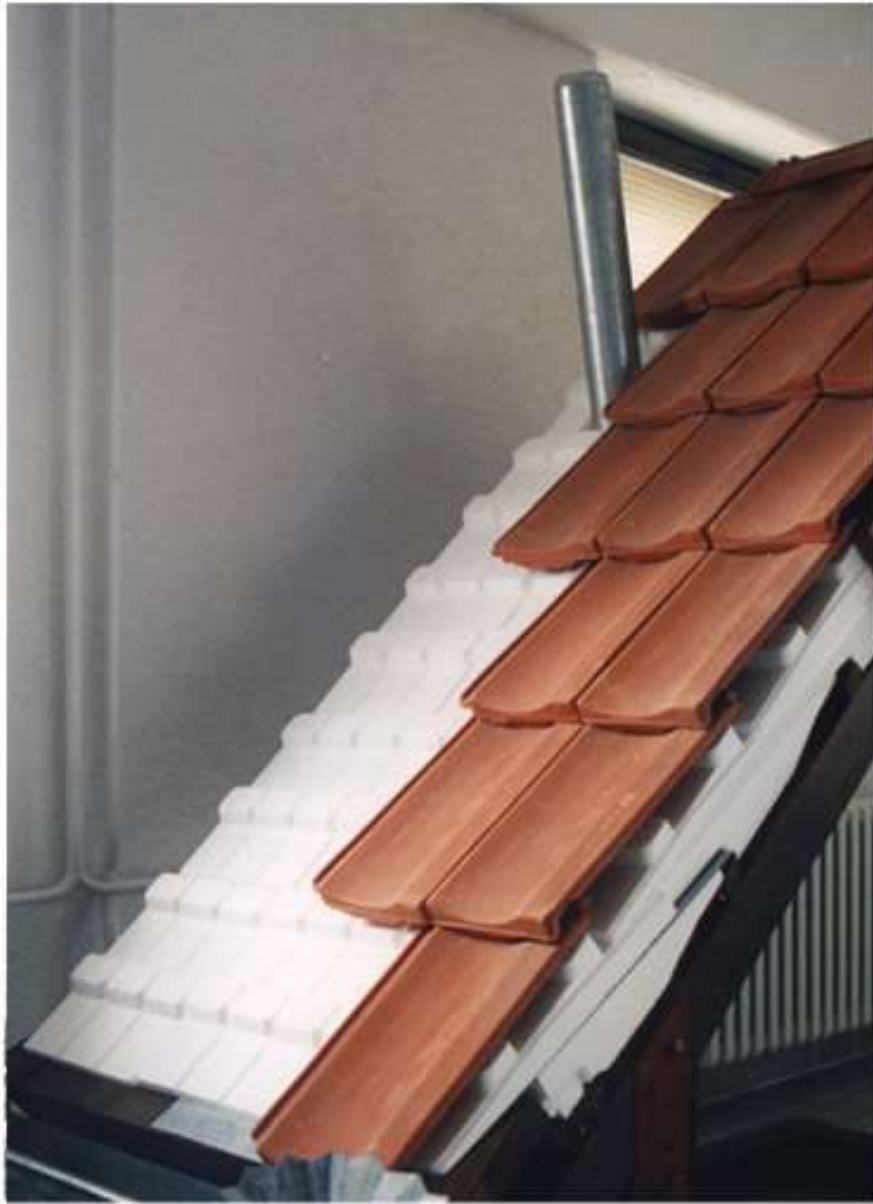
Kosi krov sa specijalno oblikovanim podmetačima od stiropora
