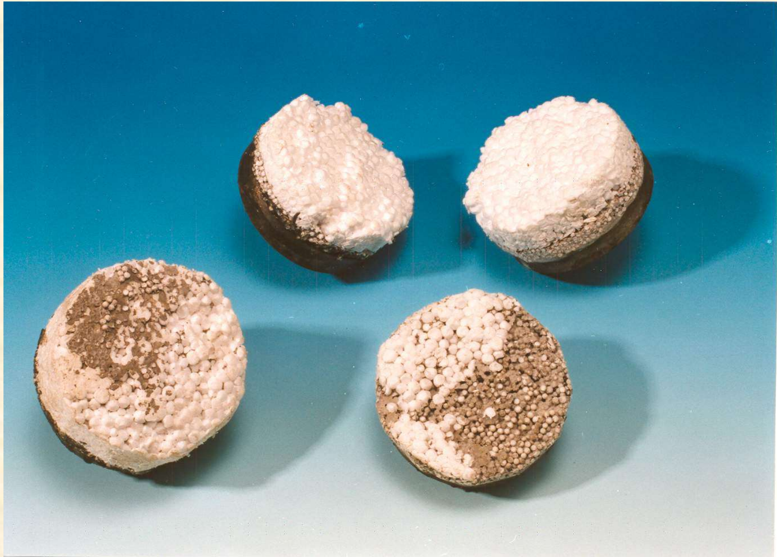
Ispitivanje athezije stiropora
