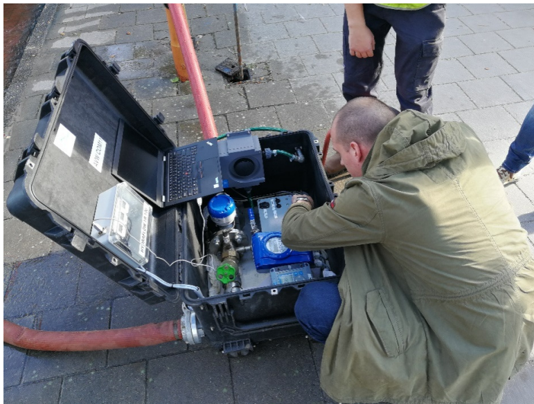
Слика 3. Излазак на терен – пређење мерења током испирања водоводне мреже
